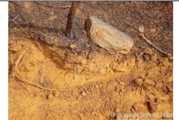
FOTO 11 – Material de 1ª categoria. Solo silto-arenoso, marrom claro, com torrões e cascalho. Espessura = 0,42 m.
