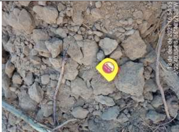
FOTO 26 – Material de 1ª categoria. Solo silto-arenoso, marrom claro, com torrões. Espessura = 0,70 m.
