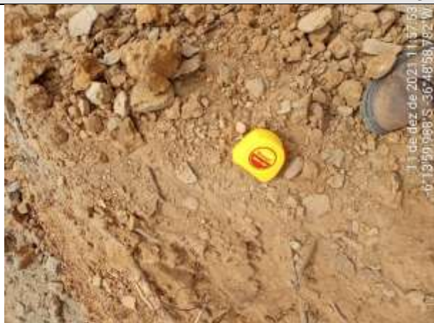
FOTO 09 – Material de 1ª categoria. Solo argilo-arenoso, marrom claro, com torrões e fragmentos de rocha. Espessura 0,83.
