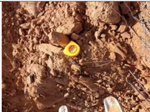
FOTO 23 – Material de 2ª categoria. Solo de alteração argilo-arenoso, marrom escuro, com torrões, fragmentos de rocha e rocha alterada mole na base. Espessura = 0,24 m. Impenetrável aos 0,50 m.
