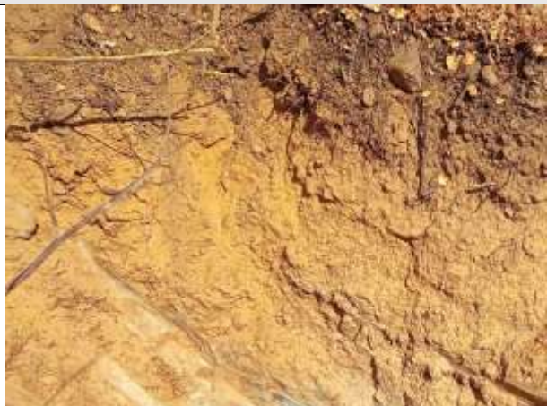
FOTO 17 – Material de 1ª categoria. Solo silto-arenoso, marrom, com torrões e cascalho. Espessura = 1,00 m.
