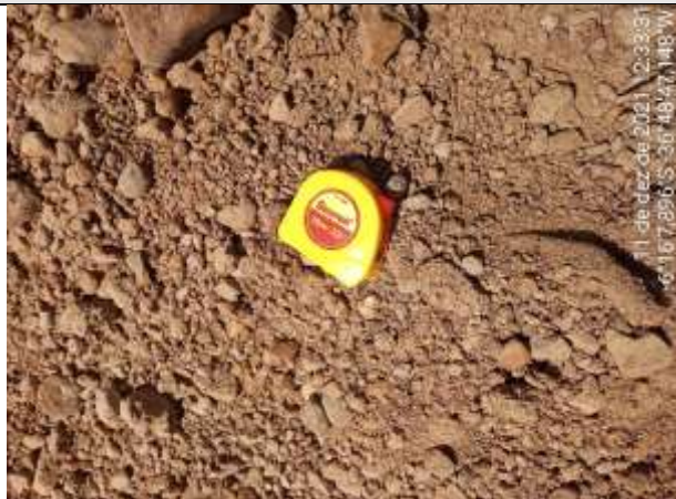
FOTO 13 – Material de 1ª categoria. Solo areno-argiloso, marrom, muito cascalhoso. Espessura = 0,38 m.
