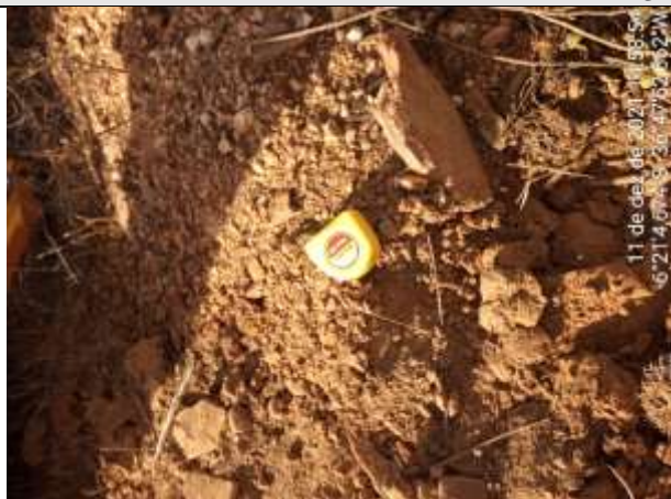
FOTO 22 – Material de 1ª categoria. Solo areno-argiloso, marrom, com torrões e cascalho. Espessura = 0,26 m.
