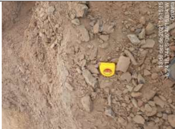
FOTO 30 – Material de 1ª categoria. Solo silto-arenoso, marrom claro, com torrões e fragmentos de rocha. Espessura = 0,80 m.
