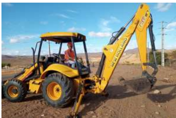
Figura 2.1 – Retroescavadeira New Holland, modelo LB90, com concha de 0,80 m de largura, utilizada na abertura das trincheiras.
