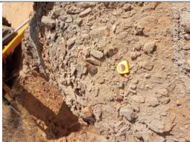
FOTO 21 – Material de 2ª categoria. Solo de alteração argilo-arenoso, cinza, com fragmentos de rocha e rocha alterada mole na base. Espessura = 0,69 m. Impenetrável aos 1,79 m.
