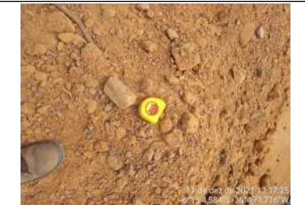
FOTO 12 – Material de 2ª categoria. Solo de alteração argilo-arenoso a silto-arenoso, marrom claro, com fragmentos de rocha. Espessura = 0,30 m. Impenetrável aos 0,72 m.
