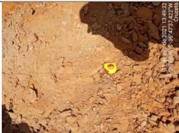
FOTO 20 – Material de 1ª categoria. Solo areno-argiloso, marrom avermelhado, com torrões e fragmentos de rocha. Espessura = 1,10 m.
