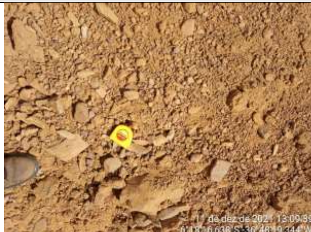
FOTO 18 – Material de 2ª categoria. Solo de alteração argilo-arenoso, marrom, com cascalho, fragmentos de rocha e rocha alterada mole na base. Espessura = 0,45 m. Impenetrável aos 01,45 m.
