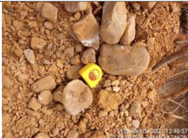
FOTO 15 – Material de 1ª categoria. Solo silto-arenoso, marrom claro, com cascalho e seixo. Espessura = 0,45 m.
