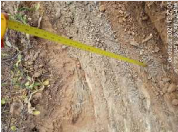
FOTO 19 – Material de 1ª categoria. Solo areno-argiloso, marrom a cinza, com cascalho, fragmentos de rocha e rocha alterada mole na base. Espessura = 0,52 m. Impenetrável aos 0,52 m.
