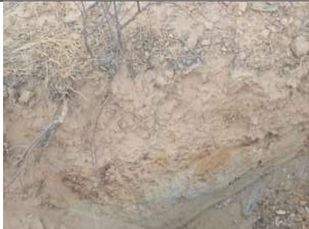
FOTO 28 – Material de 1ª categoria. Solo silto-arenoso, marrom claro, com fragmentos de rocha. Espessura = 0,75 m.
