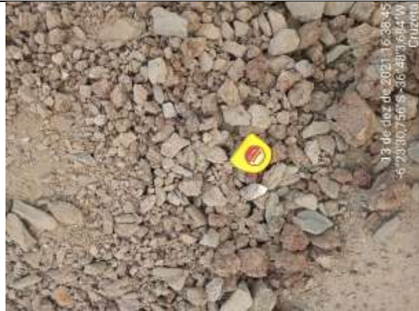
FOTO 29 – Material de 2ª categoria. Solo de alteração argilo-arenoso, marrom claro avermelhado, com torrões, fragmentos de rocha e rocha alterada mole na base. Espessura = 0,95 m. Impenetrável aos 1,70 m.
