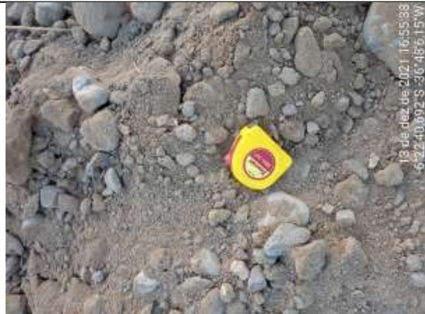
FOTO 27 – Material de 2ª categoria. Solo de alteração argilo-arenoso, marrom claro, com cascalho e fragmentos de rocha. Espessura = 0,40 m. Impenetrável aos 1,10 m.
