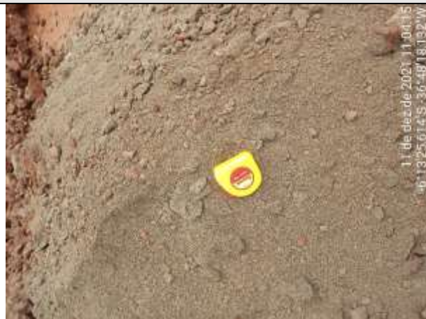
FOTO 08 – Material de 2ª categoria. Solo de alteração argilo-arenoso, cinza, com fragmentos de rocha. Atingiu 2,00 m de profundidade antes de alcançar o impenetrável, paralisando a esta profundidade.
