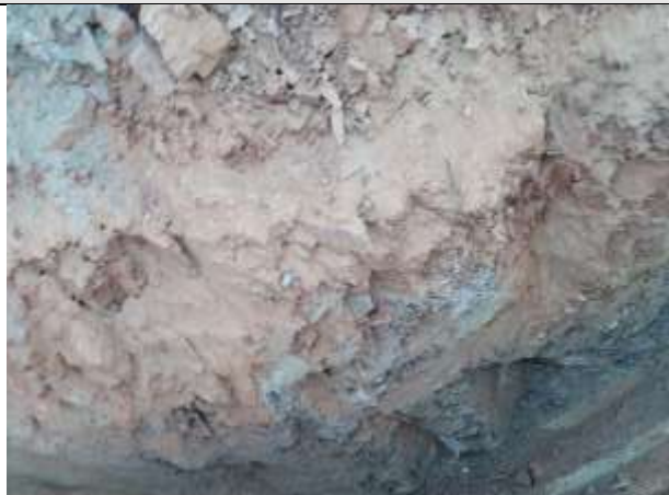
FOTO 24 – Material de 1ª categoria. Solo areno-argiloso, marrom claro, com fragmentos de rocha. Espessura = 0,62 m.
