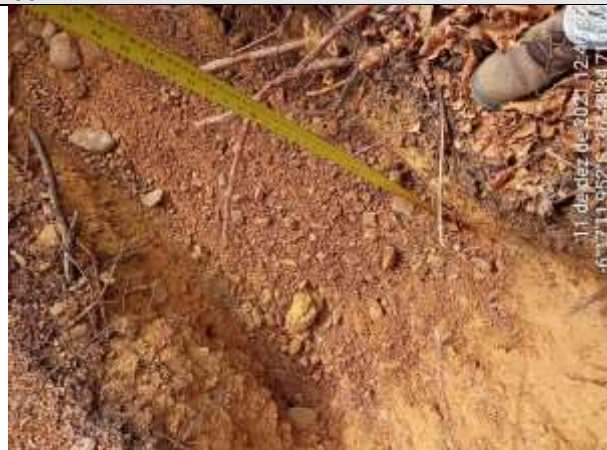
FOTO 16 – Material de 2ª categoria. Solo de alteração argilo-arenoso, marrom, com cascalho, fragmentos de rocha e rocha alterada mole na base. Espessura = 0,37 m. Impenetrável aos 0,82 m.
