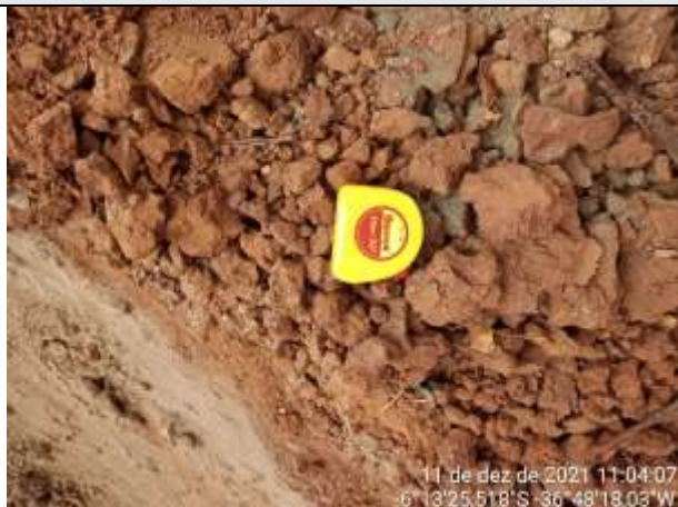
FOTO 07 – Material de 1ª categoria. Solo argilo-arenoso, marrom avermelhado, com torrões. Espessura = 0,60 m.
