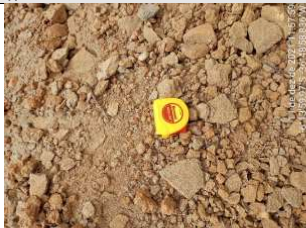
FOTO 10 – Material de 2ª categoria. Solo de alteração argilo-arenoso, cinza a marrom claro, com fragmentos de rocha, e rocha alterada mole na base. Atingiu 2,00 m de profundidade antes de alcançar o impenetrável, paralisando a esta profundidade.
